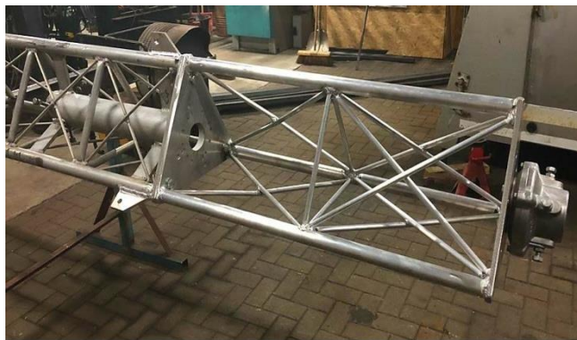
Hier nog in de werkplaats, het mastdeel met nieuwe rotor kooi.
