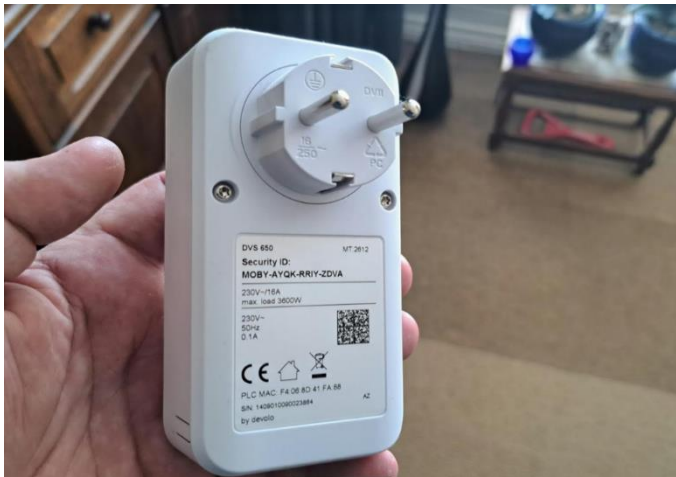
De veroorzaker van de storing: Devolo DVS 650 internet plug
