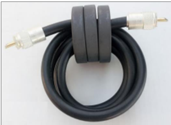
Eenvoudige RF-smoorspoel met meerdere ferrietringkernen
