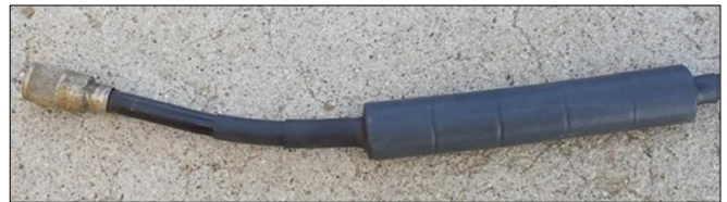
Common-mode choke met buisvormige ferriet, afgewerkt met een stuk krimpkous. Dit is niet de meest effectieve common-mode choke die je kunt maken.
