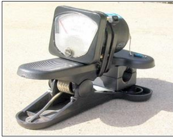
Eenvoudige zelfgemaakte RF CMC - meter
