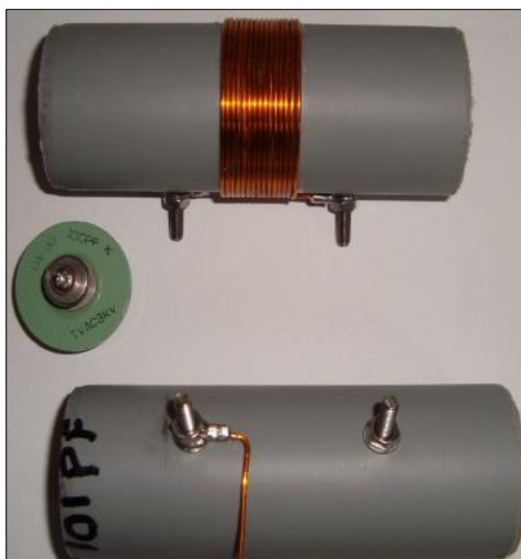
Figuur 3. Opbouw van de trap
