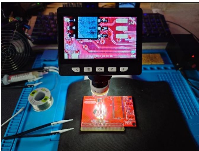
SMD solderen met behulp van een digitale microscoop
