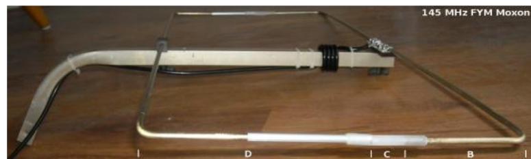
Figuur 5 Moxon gemaakt van schroot materiaal. Let op de RG213 PE-diëlektricum ('C').
