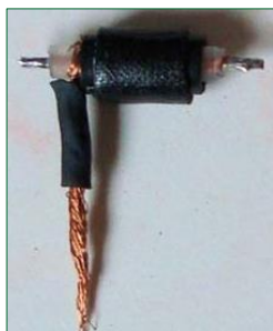
Het stukje coax met staartje voor de aarding, op de rechter foto in de kern gestoken.
