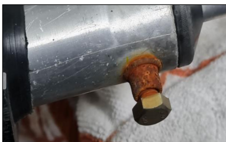
Hier zie je duidelijk de M10 bout waarmee de trap vast zit, Hier is wel wat WD40 nodig.
