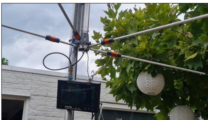
Het prototype van de nieuwe verticale antenne op een kort mastje van ongeveer 1.5 meter in testopstelling. Onder de antenne zie je de VNA SV4401A voor de resonantie en impedantie metingen.
