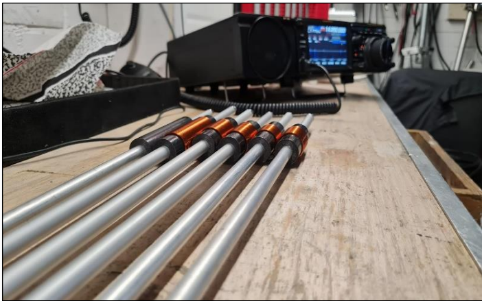
De zes afgestemde radialen, twee per band zijn bijna klaar, nog één te gaan
