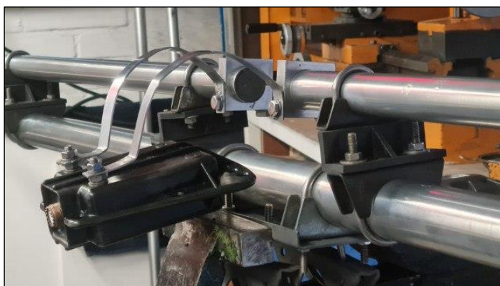
Een dipool met BalUn van een Fritzel beam
