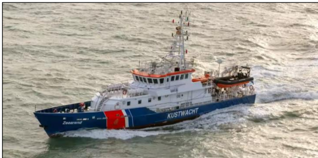
Kustwacht patrouillevaartuig Zeearend: Lengte 42.8 m, Breedte 7.11 m, Diepgang 2.6 m, Snelheid 22.5 kn. = 41,67Km/h, Voortst. 2x Caterpillar 3516B DI-TA, totaal 5.700 PK.
