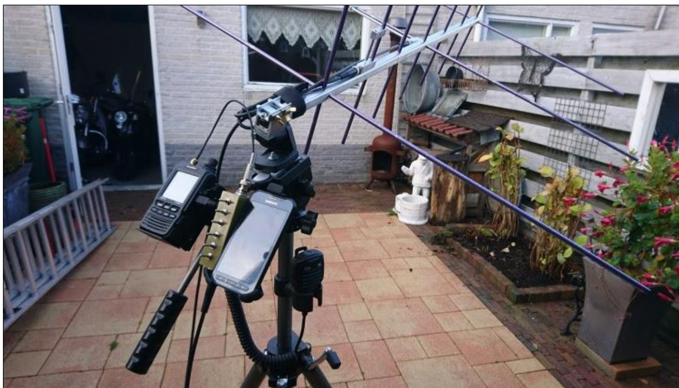
Deze antennes, zijn bedoeld om over satellieten te werken, daarom worden ze om de satelliet goed te kunnen volgen, vaak op een camera statief gemonteerd.
