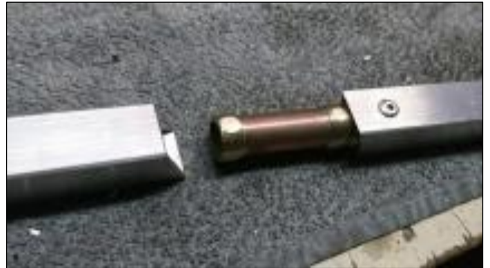
Verbinding tussen de beide delen van de boom
