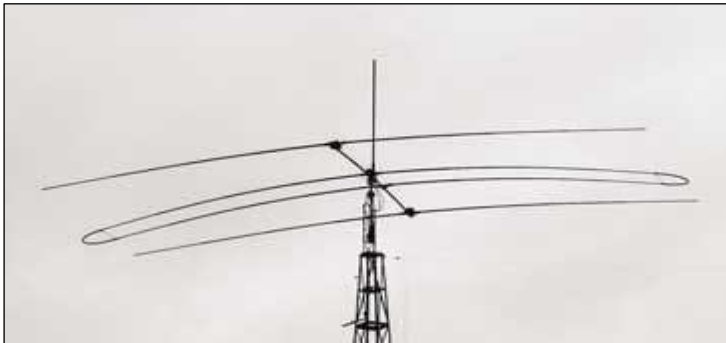
Een typische HF-richtantenne, vaak draaibaar opgesteld, die wordt gebruikt voor radiocommunicatie met behulp van ionosferische voortplanting.
