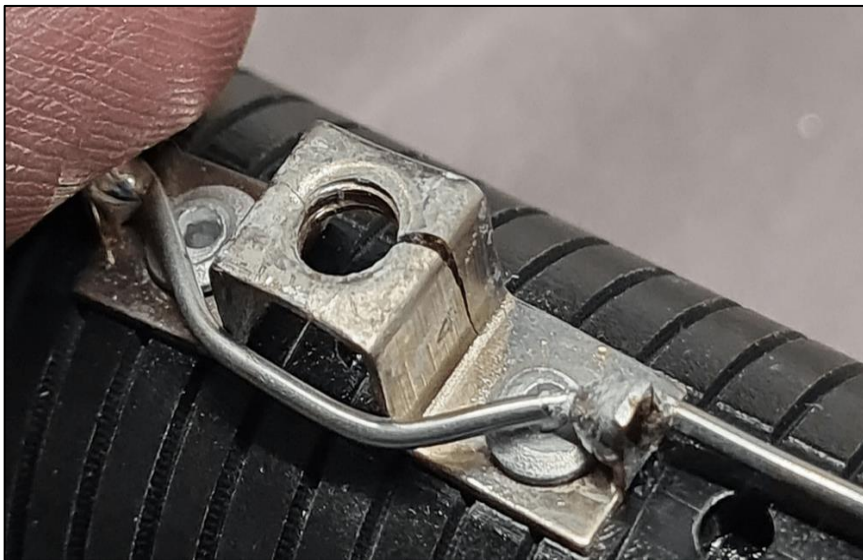
Duidelijk te zien op de foto, de ingescheurde schroefbus in de beugel
