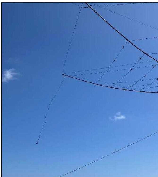
Weer een gebroken draad veroorzaakt door RF-vonken
