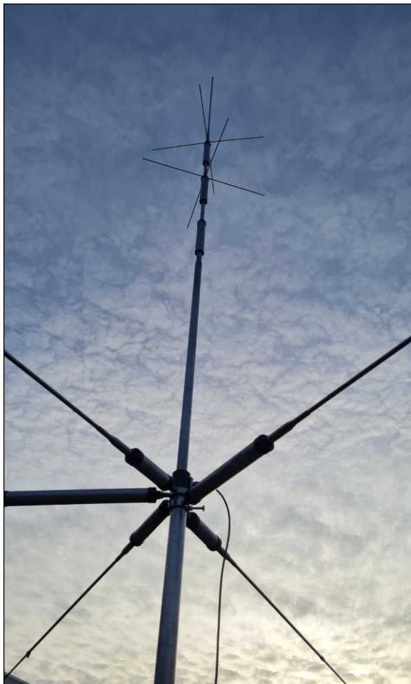
De CP-6 met duidelijk te zien, de verkorte resonante radialen
