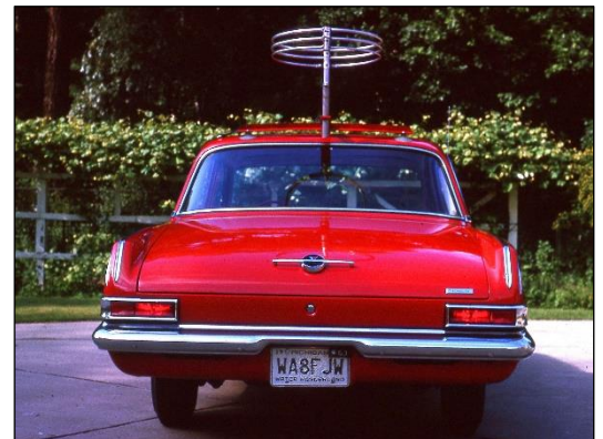
Foto uit 1963 van de auto van Harry Garland, WA8FWJ. De antenne is een horizontaal gepolariseerde halo-antenne voor de 6 meterband. De auto is een Plymouth Valiant (Foto: GarlandFamily, CC-BY-SA-4.0 Self-published work)
