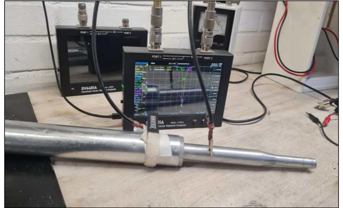
Zo moet het dus niet, trap ligt op de werkbank, dit geeft meetfouten.
