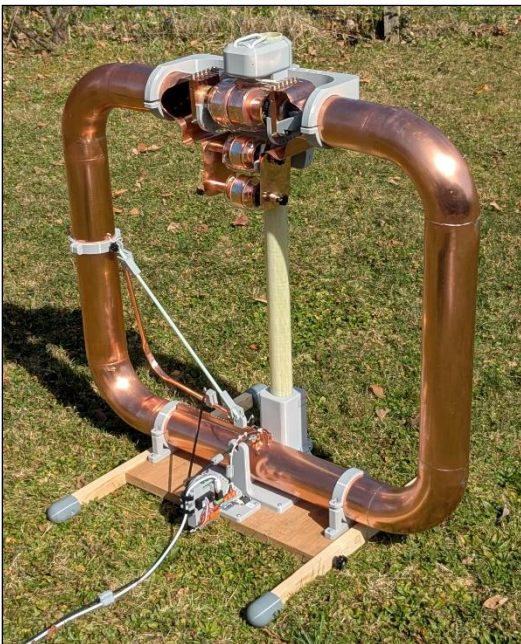
Low-loss magnetische loopantenne van 100 mm diameter buis. Omsloten oppervlak is 0,78 mm 2 , afstemming met vacuüm condensatoren. Auteur: Petermaerki, March 2026, CC-BY-SA-4.0 Wikimedia
