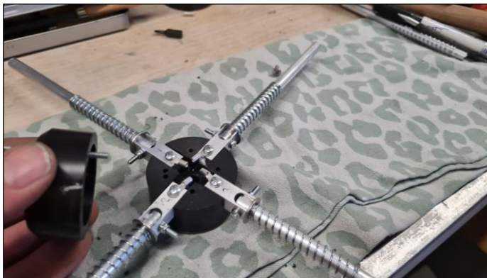
De beide dipolen, hier nog zonder coax kabels, later met de coaxkabels gemonteerd bleek bij meting toch het een en ander toch niet te kloppen.
