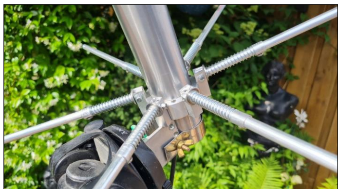
De gemonteerde reflectoren
