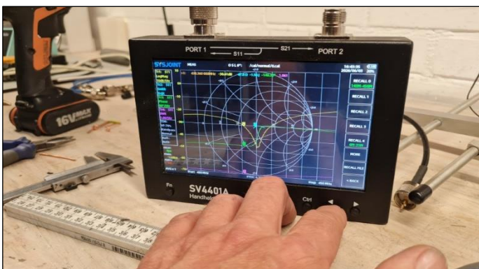
De impedantie, de reactantie en de positie op de Smith-chart vertellen vaak een veel completer verhaal.
