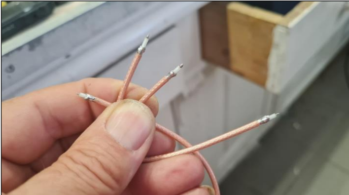
RG-316 met vertinde afscherming, dit bleek een grote verbetering t.o.v. RG-58
