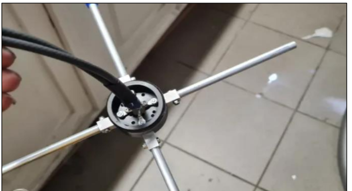
De kabels (hier nog RG-58) gemonteerd aan de straler
