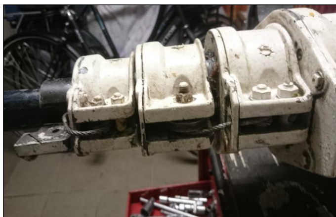
De eerste inspectie, het is bijna niet te zien, maar in het midden is de kabel van het wiel gelopen.
