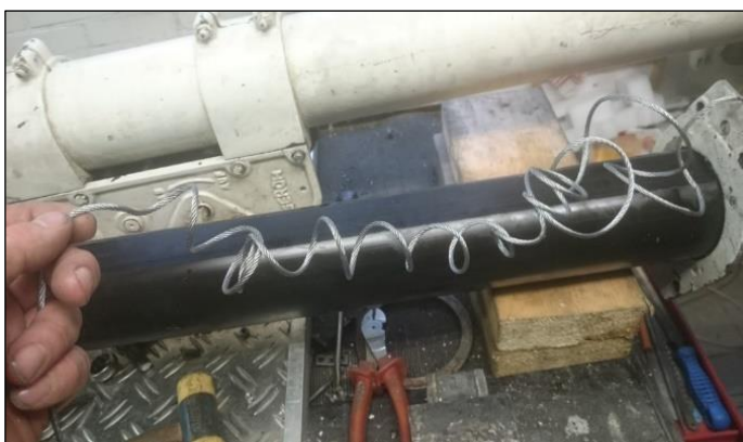
Hier zie je de beschadigde staalkabel
