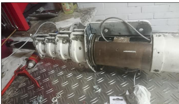
Smeren van de mast
