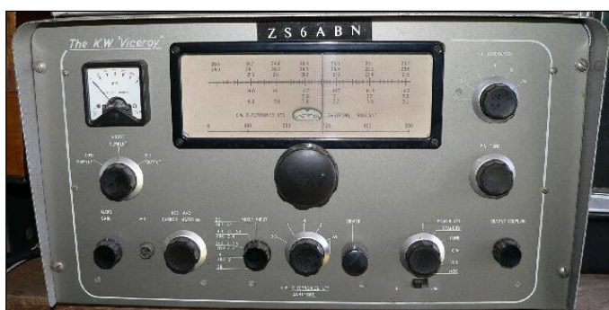
KW Viceroy Mark III SSB-zender voor 80-40-20-15 en 10 meter, output \pm 100 Watt. Dit is alleen de zender, de ontvanger was vroeger een los apparaat.
